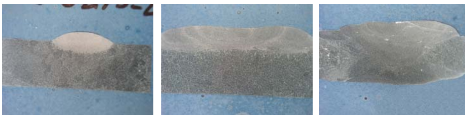
Rys. 4. Makrostruktury wykonanych napoin oraz spoiny (tabl. 2, poz.4-6) Fig. 4. Macrostructures of welds and padding welds executed (Table 2, pos 4-6)
