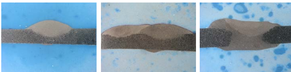
Rys. 3. Makrostruktury wykonanych napoin oraz spoiny (tabl. 2, poz.1-3) Fig. 3. Macrostructures of welds and padding welds executed (Table 2, pos. 1-3)
