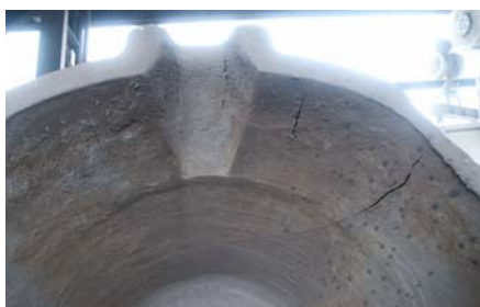
Rys. 5. Pęknięcie wzdłużne dna Fig. 5. Lengthwise crack in the ladle bottom
