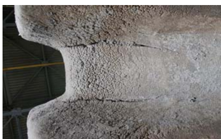
Rys. 1. Pęknięcia wylewów i siatka pęknięć Fig. 1. Cracks and crazing in the ladle nozzle
