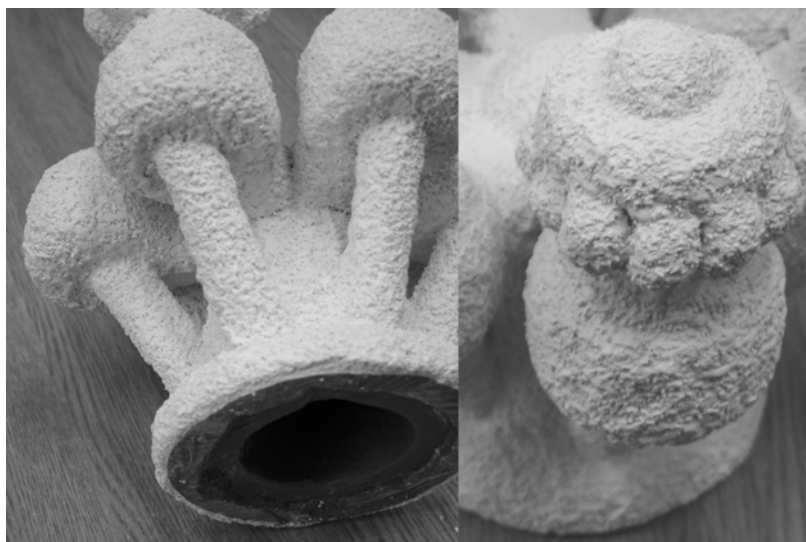
Rys. 6. Forma ceramiczna wirnika turbiny Fig. 6. Casting mould of rotor of turbine
