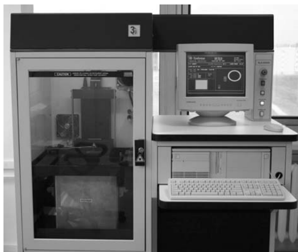
Rys. 4. Aparatura stereolitograficzna SLA 250 Fig. 4. SLA 250 Machine
