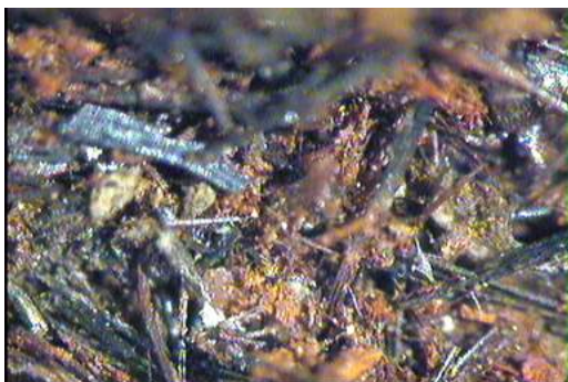
Rys. 3. Materiał „Sprayed coating” po mikrofalowej obróbce Fig. 3. Material „Sprayed coating” after microwave treatment
