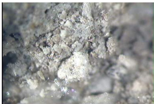
Rys. 2. Materiał „Cement panel” po mikrofalowej obróbce Fig. 2. Material „Cement panel” after microwave treatment
