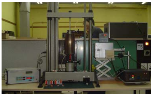
Rys. 1. Widok stanowiska do badań wytrzymałości w podwyższonej temperaturze
