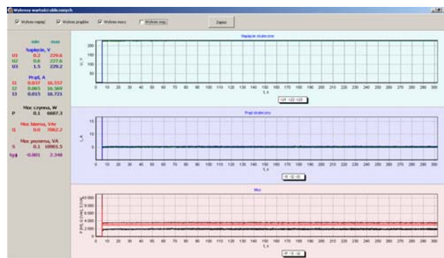
Rys. 6. Widok okienka z przebiegami wartości skutecznych napięć i prądów oraz poszczególnych składników mocy (mieszarka łopatkowa z ładunkiem 50 kg masy)
