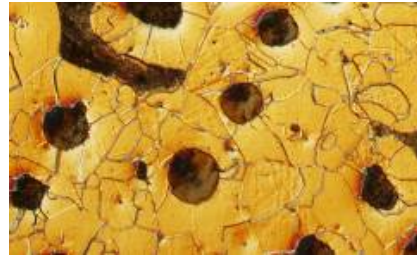
Rys. 4. Mikrostruktura żeliwa – próbka o grubości 40 mm Fig. 4. Microstructure of nodular cast iron – sample 40
