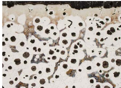
Rys. 7. Mikrostruktura żeliwa sferoidalnego próbki 40 przy powierzchni Fig. 7. Microstructure of nodular cast iron of sample 40 at surface
