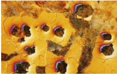
Rys. 3. Mikrostruktura żeliwa – próbka o grubości 10 mm Fig. 3. Microstructure of nodular cast iron – sample 10
