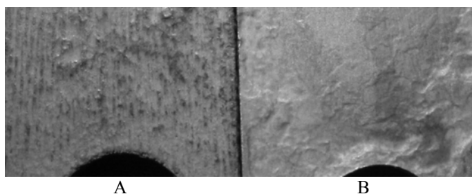
Rys. 4. Obraz korozji żeliwa sferoidalnego (A) i stali St37 (B) po ekspozycji w instalacji wody termalnej w ciągu 90 dni (pow. 4x) Fig. 4. Image of corrosion of spheroidal cast iron (A) and St37 steel (B) in geothermal plant after 90 days (magn. 4x)
