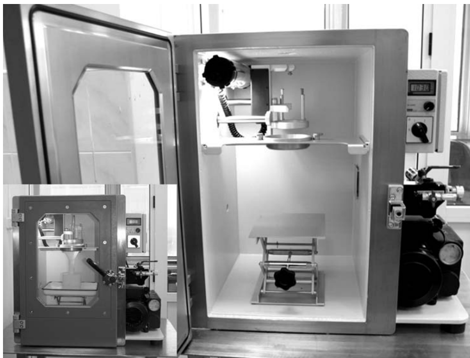
Rys. 2. Aparatura do odlewania próżniowego typu VAKUUM UHG 400 Fig 2. Vacuum casting machine type VAKUUM UHG 400
