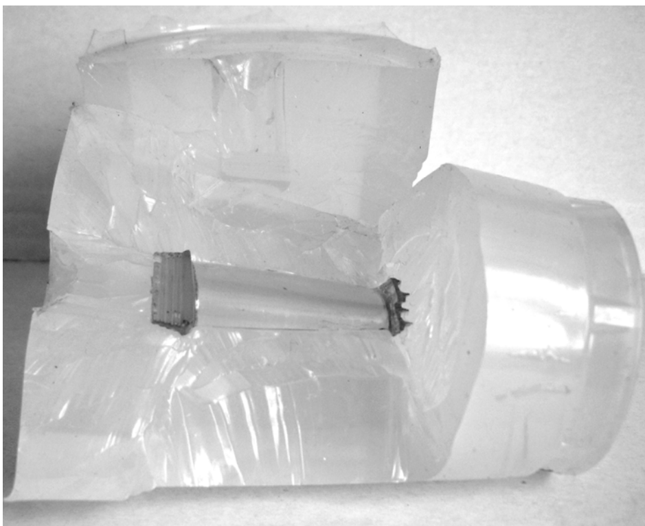
Rys. 3. Fragment matrycy silikonowej ze stereolitograficznym modelem łopaty Fig. 3. Part of silicon mould with stereolithography model of blade
