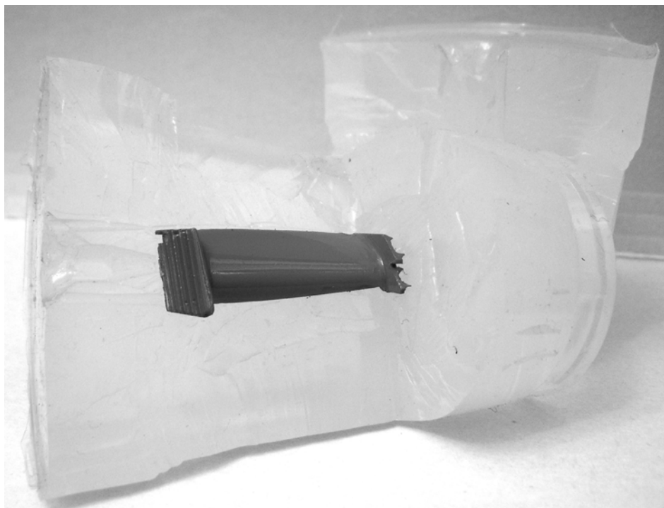
Rys. 4. Model woskowy łopatki w matrycy silikonowej Fig. 4. Investment pattern of blade in silicone mould
