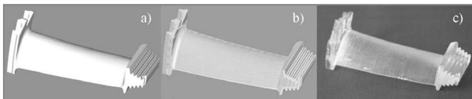
Rys. 1. Tworzenie stereolitograficznego modelu łopatki wirnika: a) model CAD, b) model STL, c) model SLA
