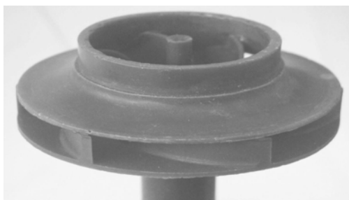
Rys. 2. Model woskowy złożony przygotowany do wykonania formy odlewniczej
