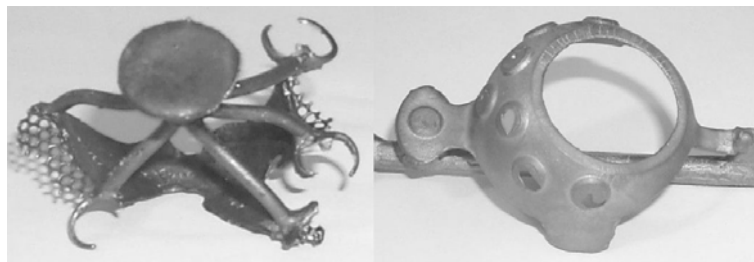
Rys. 5. Proteza dentystyczna i proteza stawu kolanowego – odlewy z tytanu Fig. 5. Dental prosthesis and prosthesis of knee joint - a titanium casting
