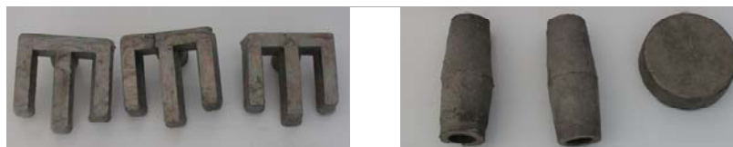
Rys. 4. Elementy kształtowe odlane pod ciśnieniem odśrodkowym ze stopu Fe-Al Fig. 4. Centrifugal casting of Fe-Al fixtures
