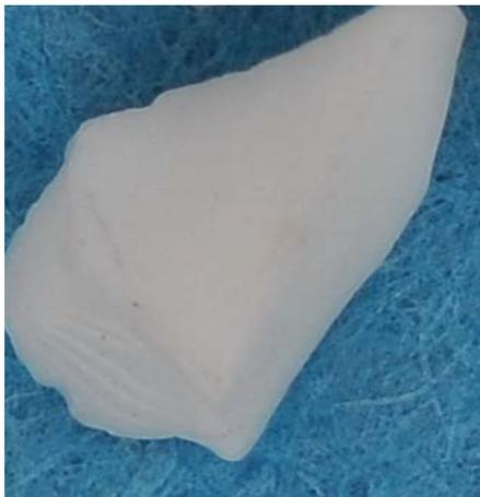
Fig. 2. Exterior grit Cubitron (CB) with submikrokrystalicznego sintered alumina [1]
