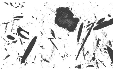
Rys. 9. Pęcherzyk gazowy zaobserwowany w strukturze próbki kompozytu nasyconego SIBRAL – AlSi11. Pow. 375x
