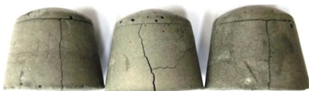
Rys. 4. Próbkę z roztworu NaOH 10%
