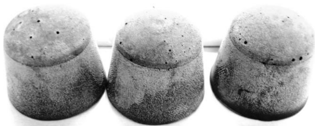
Rys. 7 Próbki z roztworu HCl 30%
