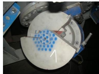
Rys. 2. Przykład wzajemnego ustawienia kół zamachowych (mas niewyważonych) elektrowibratora
