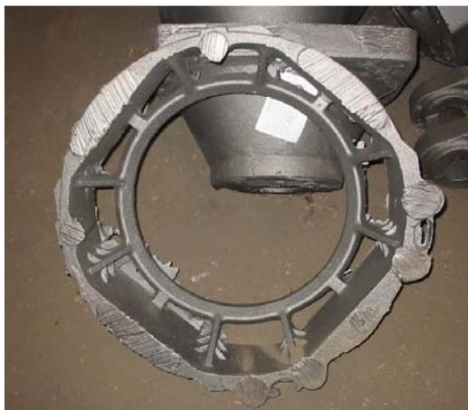
Fig. 6. Cast „Skrinja“ alloy GS 45.3. gross charge 102 kg
