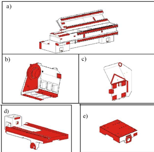
Fig. 7. The castings destined to be mounted into the CNC lathe; the red surfaces are to be machined: a) cradle, b) Odlew wchodzące w skład średniej wielkości tokarki sterowanej numerycznie, kolorem czerwonym oznaczono powierzchnie obrabiane: a) łożo, b) fixed headstock, c) tailstock, d) slide Z, e) slide X
